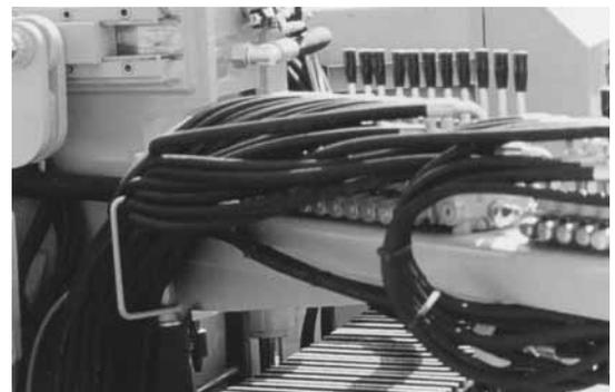
Le flexible Shieldmaster est disponible dans diverses exécutions, parmi lesquelles les exécutions **2000, 5000 et 6000 PSI**. Ces flexibles sont assemblés avec les coupleurs de flexibles et jupes MF2000 standard.
